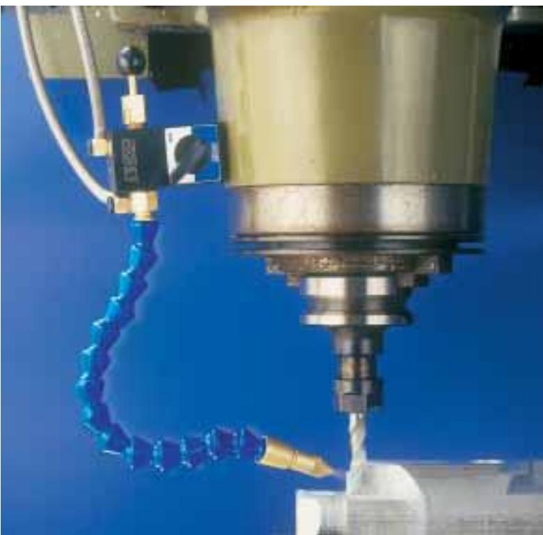
Unidad autónoma que funciona con aire comprimido y líquido. Se consigue una mezcla de aire y líquido, regulable a voluntad y fácil de posicionarlo en el lugar preciso, mediante una base magnética on/off o atornillándolo para múltiples aplicaciones de refrigeración en sierras, roscadoras, centros CNC, prensas de estampación, etc.
